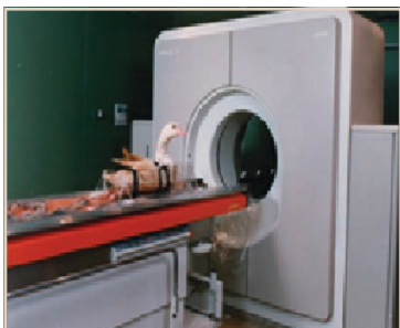
21. kép: Lúd CT vizsgálata a máj méretének és összetételének mérésére
