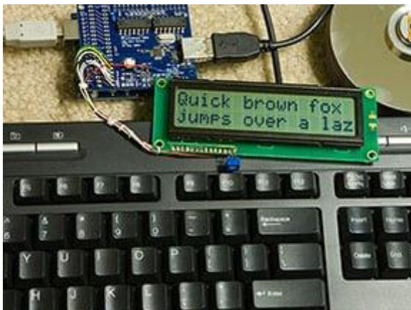
56. ábra: Arduino-val vezérelt billentyűzet és LCD
