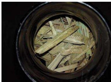
2. ábra: A perkollációs vizsgálat során alkalmazott, avarral töltött üvegpalack.
