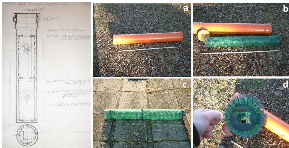
1. ábra. Ikrázófészek: balra: tervrajz. Jobbra; a) zárható szállító tok, b) szállító tok és a végein nyitott hengerpalást alapú ívási szubsztrát, c-d) ívási szubsztrát oldalról és felülről, belül a merevítő egységekkel, kívül az ikrák sérülését a szállítótokban megakadályozandó gumibakok. Tervrajzot és a prototípust készítette id. Müller Ferenc.
